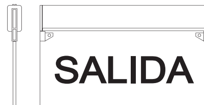
Este modelo tienen la opción de montarse en techo, muro o como bandera.
